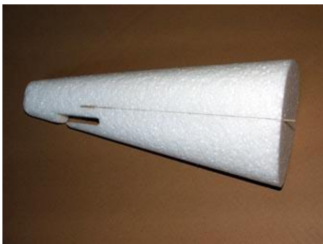
11) do zadní části trupu zhotovit zářez pro bovden
