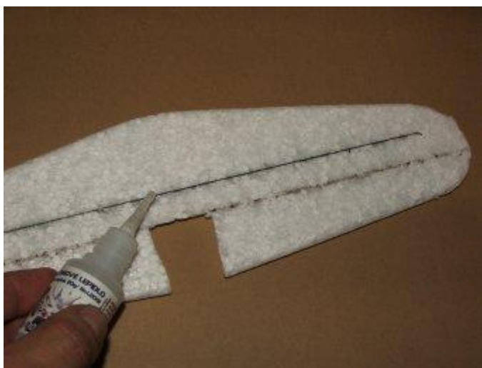
17) prořízneme drážku a zalepíme uhlíkový pásek
