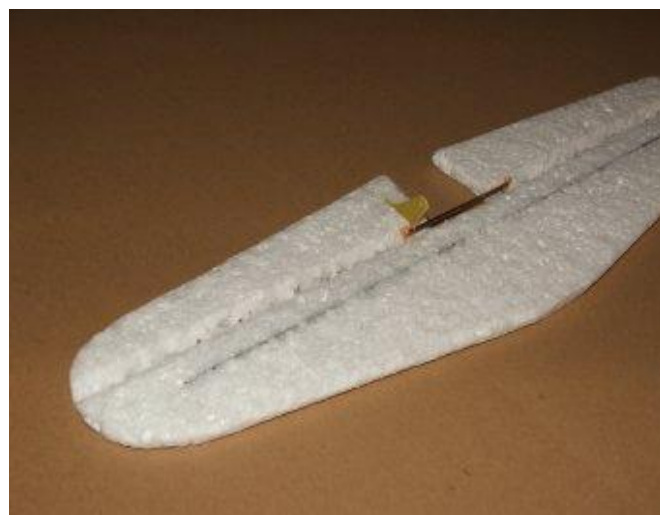
18) poloviny kormidla spojíme drátem ohnutým do „U“ Do vyřízlé drážky zalepíme vteřinovým lepidlem ovládací páku.
