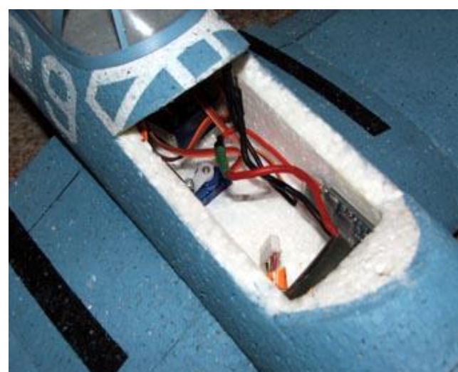
23) RC soupravu umístíme dle potřeby. Akumulátor co nejvíce dopředu.
