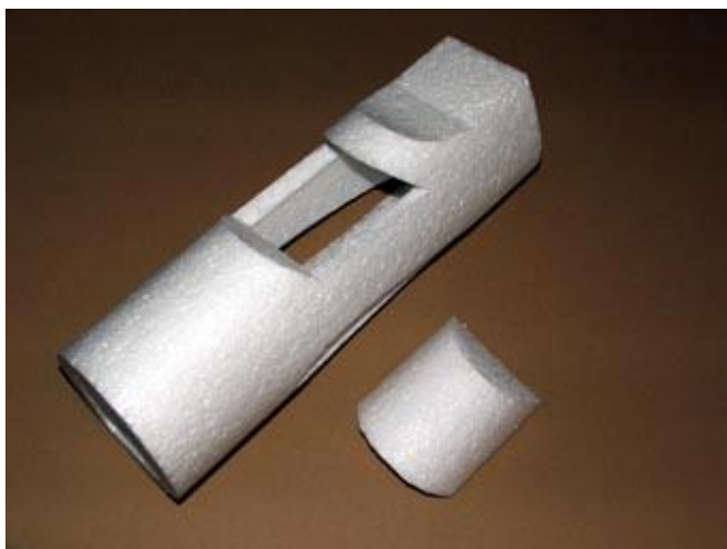
9) odříznout odnímací kryt
