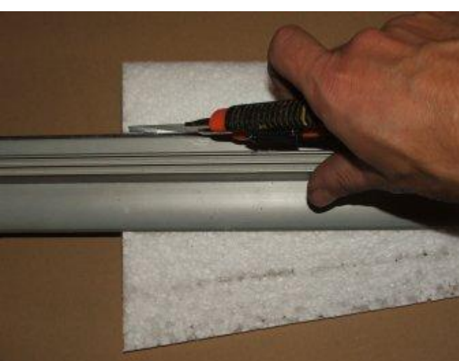
6) ostrým nožem zaříznout zářez pro uhlíkový pásek
